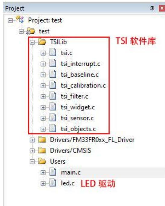
接下来，我们编写 main.c 文件，调用 TSI 软件库接口，完成 TSI 软件库的初始化/启动，以及按键状态读取、背光控制和三色彩灯调色调亮度的功能。我们将部分代码片段展示如下，完整工程请见 [TSI 彩灯 DEMO 工程](#)。
