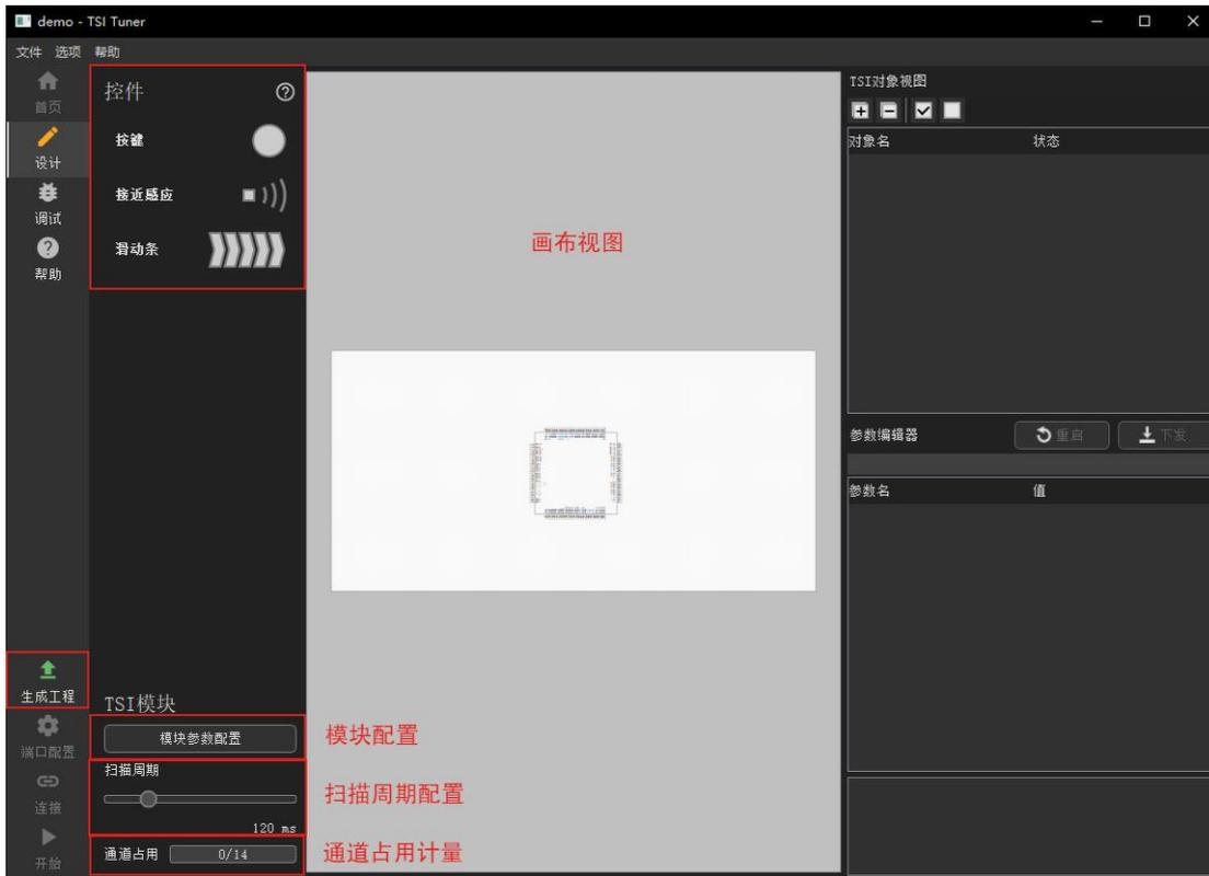
位于设计页面中央的是画布视图，用于浏览操作设计图纸。图纸设计操作按键如下：
