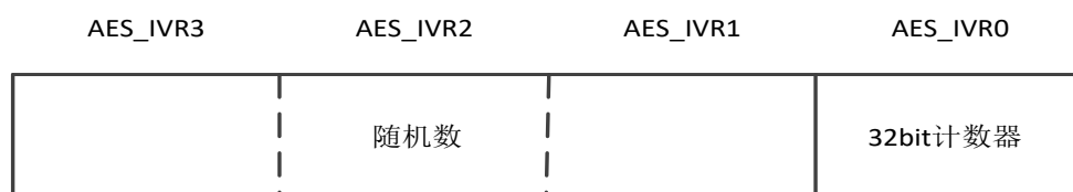
图 9-8 32 位计数器和随机数的存储方式
