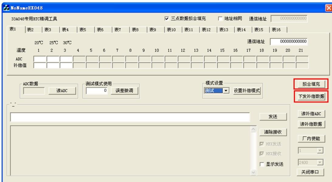
下发补偿数据完成后，选择“查表”点击“设置补偿模式”，即可结束（下发补偿数据按钮会自动打开查表模式），下发后可通过点击“读补偿 ADC”确认补偿模式已经切换到“查表模式”。点击“读补偿 ADC”后 ADC 及接收的数据如下图所示。
