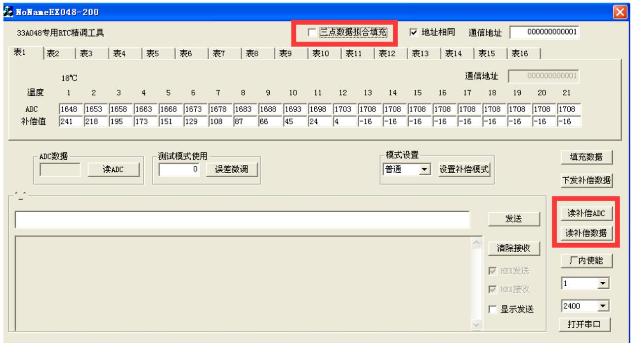
点击“读 ADC”按钮，读取当前温度下 ADC 值，
