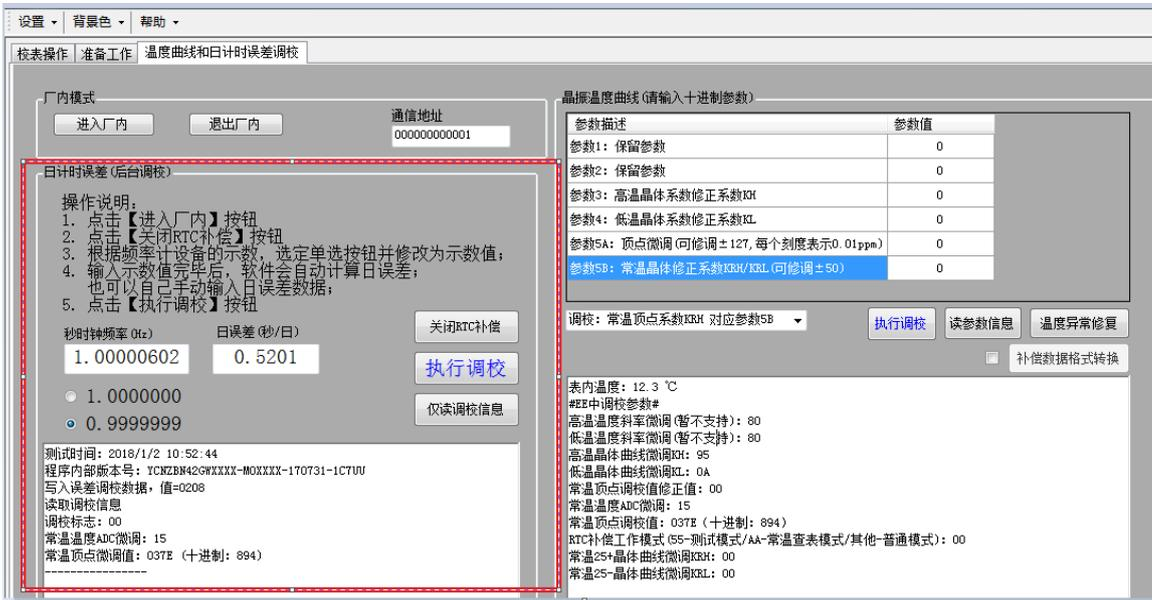
1. 不用盖表盖, 连接秒脉冲、485(或载波), 上电测试秒脉冲、通信是否正常;
