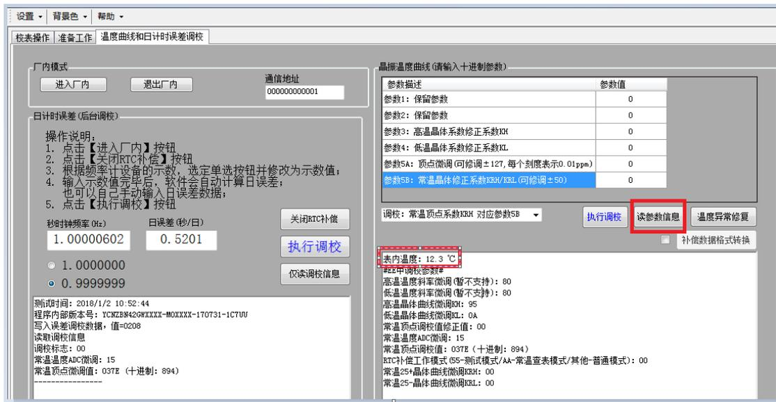
6. 点击“关闭RTC 补偿”，此时频率计屏幕会显示当前时钟频率值。
