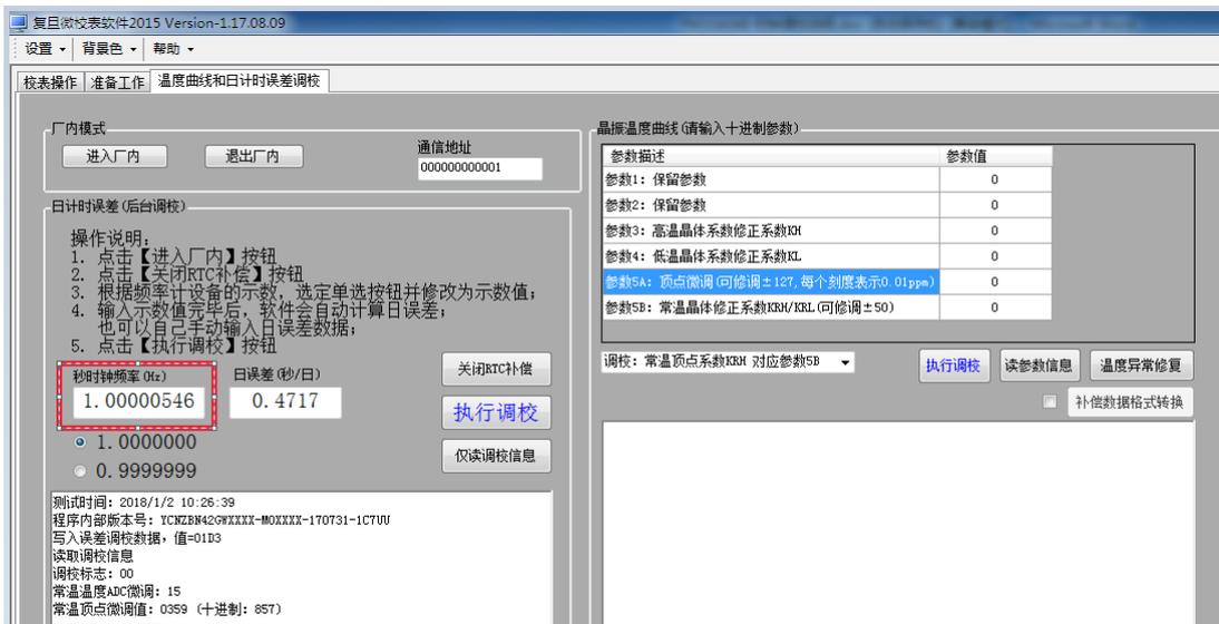
8. 点击“执行调校”，此时屏幕应当显示调校后的值。若此步骤后，时钟未能达到要求（频率计显示示值4次平均值能达到0.9999997~1.0000003之间），则可以重试上述步骤6、7、8。
