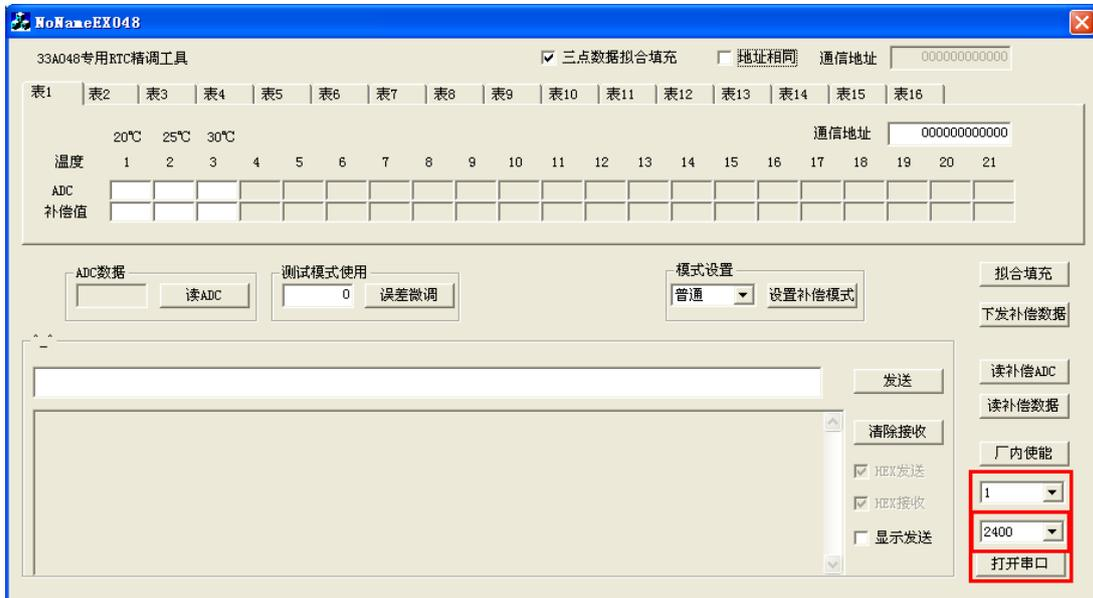
填写被测电表通讯地址，根据实际情况填写波特率使用不同地址测试，点击“厂内使能”按钮。如果失败请确认电表是否已经进入厂内模式。
