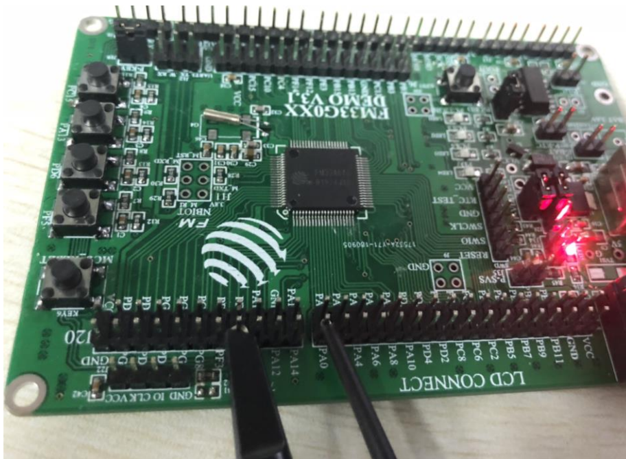
图 2-13 示波器测试唤醒时间探头连接实图
