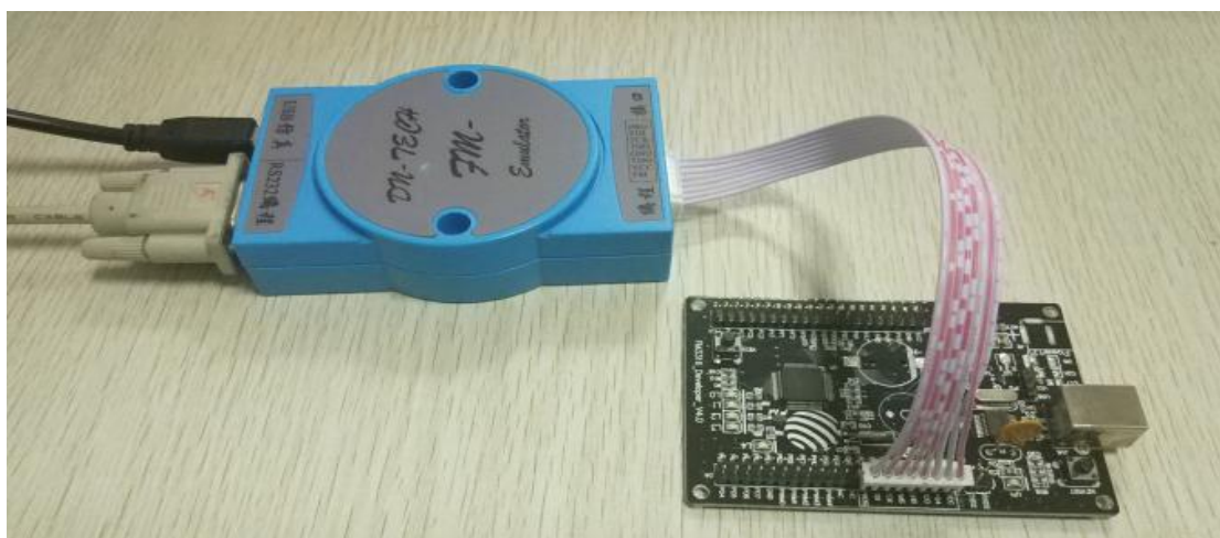
图 2-2 塑料盒仿真器 + demo 板接线
