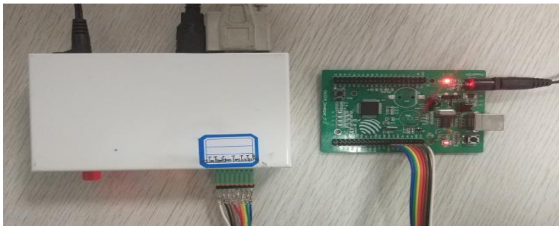
图 2-1 金属盒仿真器 + demo 板接线
